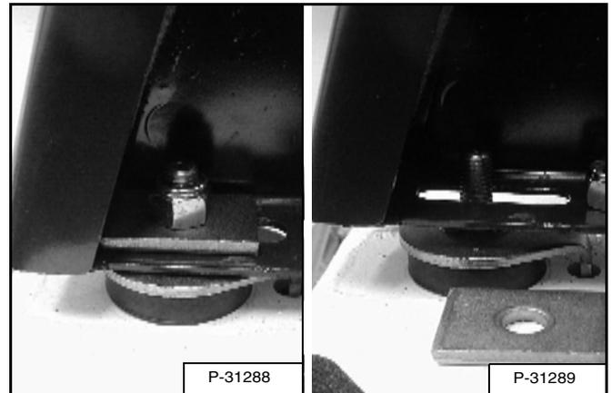
Montez les plaques et les écrous (des deux côtés) [Figure PM-18].
