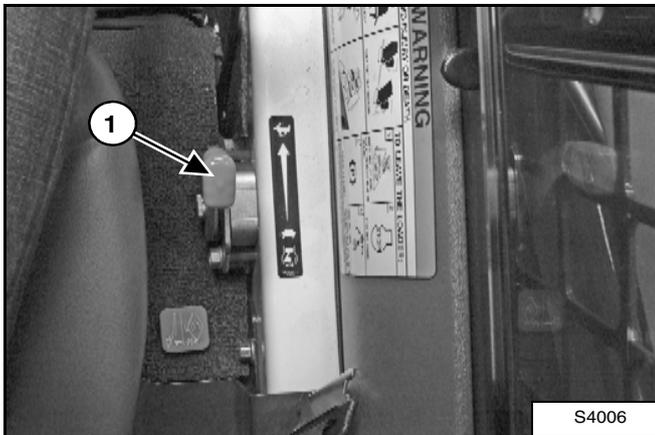
La commande d'accélérateur se trouve à droite du siège de l'opérateur (1) [Figure OI-26].
