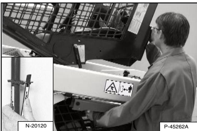
Tirez vers le bas la partie inférieure de la cabine jusqu'à ce qu'elle se cale sur le mécanisme de verrouillage [Figure PM-17].
