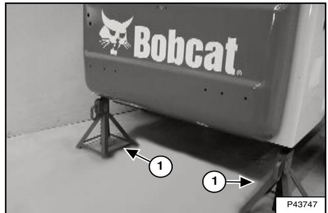
Placez des chandelles (1) [Figure PM-5] sous les coins arrière du châssis de la chargeuse.
