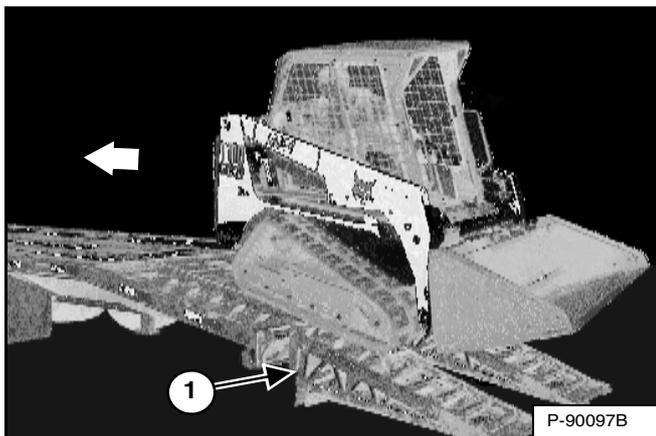
Faites monter la chargeuse en marche arrière sur le véhicule de transport si le godet est vide, ou si l'accessoire a été déposé [Figure OI-138].
