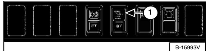
Appuyez sur le haut du contacteur de MISE À NIVEAU AUTOMATIQUE DU GODET (1) [Figure OI-53] pour activer la fonction de mise à niveau automatique du godet. Le témoin orange du contacteur s'allume. Appuyez sur le bas du contacteur pour désactiver cette fonction. Le témoin orange s'éteint.
