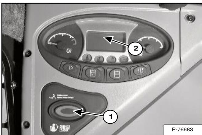
Enfoncez le bouton PRESS TO OPERATE LOADER (1) [Figure OI-80] pour activer le système BICS™ et les fonctions hydrauliques de la chargeuse.
