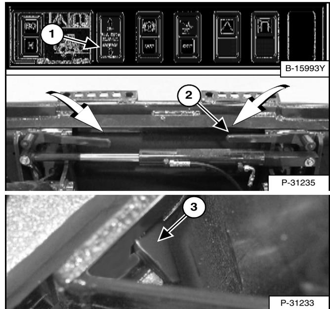
Maintenez enfoncé le côté DOWN du contacteur « BOB-TACH WEDGES » (descente des cales) (panneau avant) (1) jusqu'à ce que les leviers soient en position verrouillée (2) [Figure OI-106] (cales complètement abaissées).
