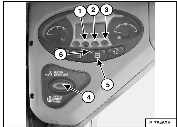
1. Installez-vous dans le siège de l'opérateur. Tournez la clé en position RUN (MARCHE) ou appuyez sur le bouton RUN. Abaissez l'arceau de siège et libérez le frein de stationnement. Appuyez sur le bouton PRESS TO OPERATE LOADER (4). Deux témoins BICS™ (1 et 2) [Figure PM-1] [ARCEAU DE SIÈGE et LEVAGE ET CAVAGE] du tableau de bord gauche doivent être ÉTEINTS. Le bouton PRESS TO OPERATE LOADER doit s'allumer.
