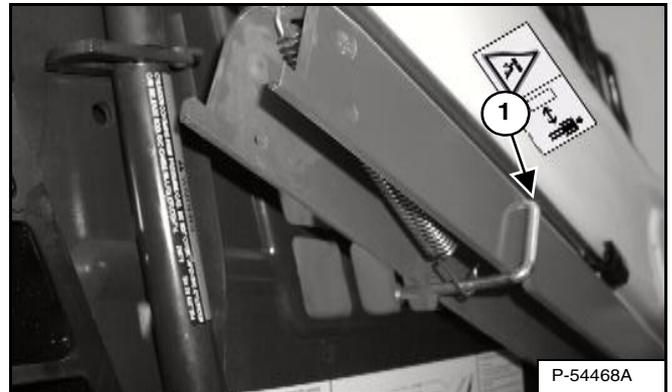
Relevez légèrement les bras de levage. Le ressort dégagera le dispositif d'arrêt de la tige du vérin de levage. Abaissez les bras de levage. Arrêtez le moteur.
