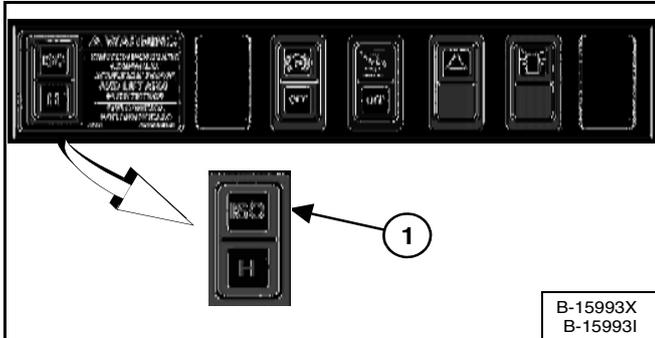
Sélectionnez le schéma de commande ISO en appuyant sur le haut du contacteur (1) [Figure OI-30].
