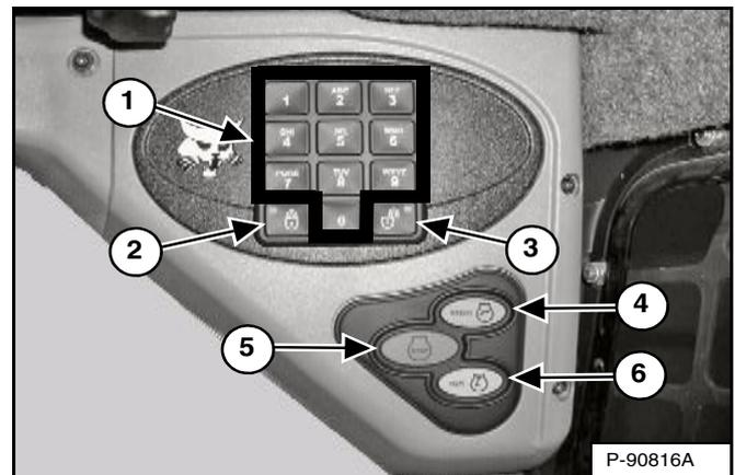
Cette machine peut être équipée d'un tableau à démarrage sans clé [Figure OI-8].
