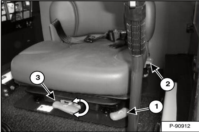
Levez le levier (1) [Figure OI-71] et réglez la position du siège de manière à manipuler confortablement les commandes de la chargeuse.
