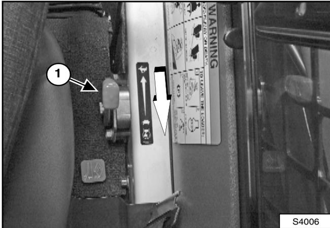
Tirez le levier de commande d'accélérateur (1) [Figure OI-92] à fond vers l'arrière pour réduire le régime moteur.
