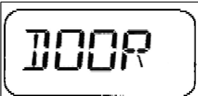
Le témoin LEVAGE ET CAVAGE (3) [Figure PM-19] reste ALLUMÉ lorsque la porte est ouverte, que le contacteur à clé est mis en position Marche (RUN) ou que le bouton RUN / ENTER est enfoncé, que l'arceau de siège est abaissé et que le bouton PRESS TO OPERATE LOADER est enfoncé.
