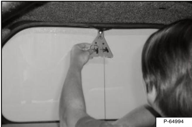
Tirez sur la boucle en haut de la vitre arrière pour retirer le cordon en caoutchouc [Figure OI-21].
