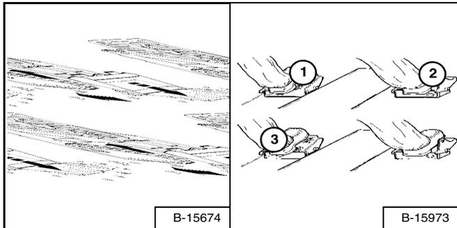
Placez les bras de levage en position de *flottement* en enfonçant complètement l'avant de la pédale (1) [Figure OI-121] jusqu'à ce qu'elle se verrouille dans cette position.
