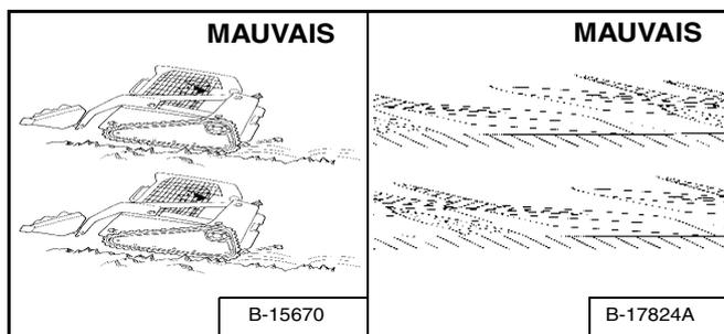
Évitez de circuler ou de tourner sur des obstacles pointus comme des pointes de rocher, des blocs de béton, des gravats de carrière ou des déchets de ferraille. Ils risquent d'entailler les crampons des chenilles [Figure OI-113].
