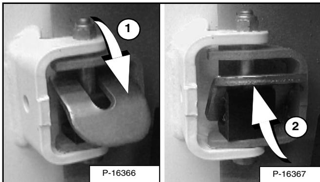
Placez l'arrêt de porte en position de verrouillage (1) [Figure PM-22] pour maintenir la porte ouverte.
