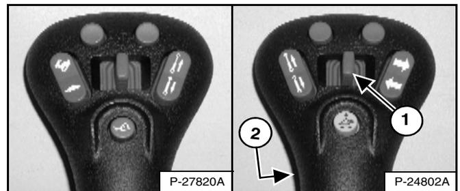
Enfoncez le contacteur avant (2) [Figure OI-60] pour alimenter les raccords rapides avant par un débit constant avec pressurisation du raccord femelle. (exemple : utilisation d'une pelle rétro).
