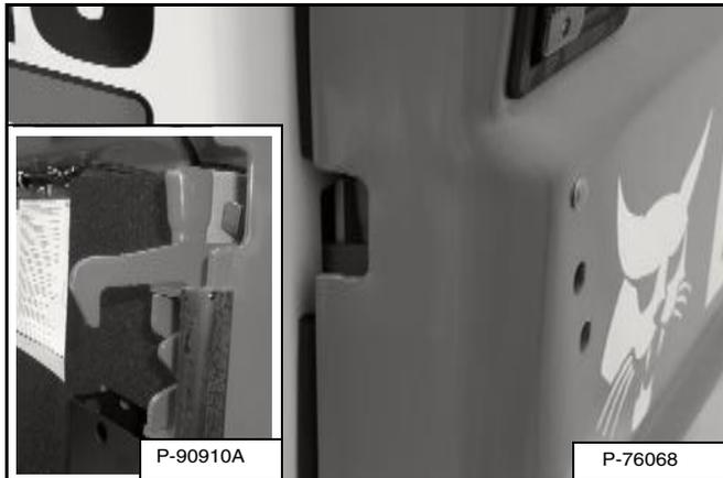
Passez la main dans l'encoche de la porte arrière et tirez la poignée du loquet [Figure PM-21].
