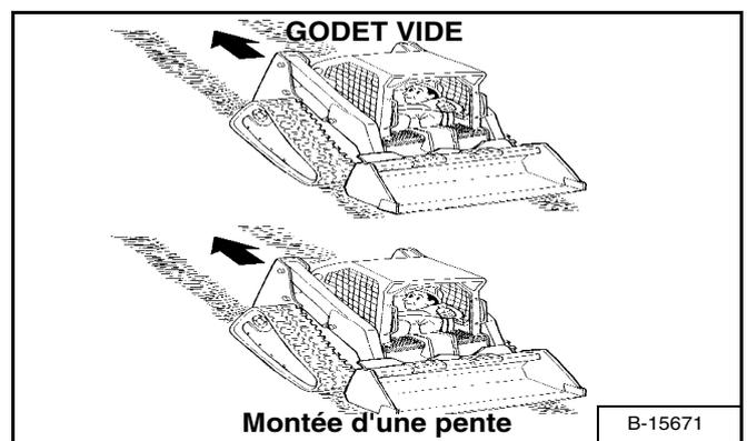
Quand le godet est vide, montez ou descendez une pente en dirigeant l'extrémité lourde de la machine vers le haut de la pente [Figure OI-116] et [Figure OI-117].
