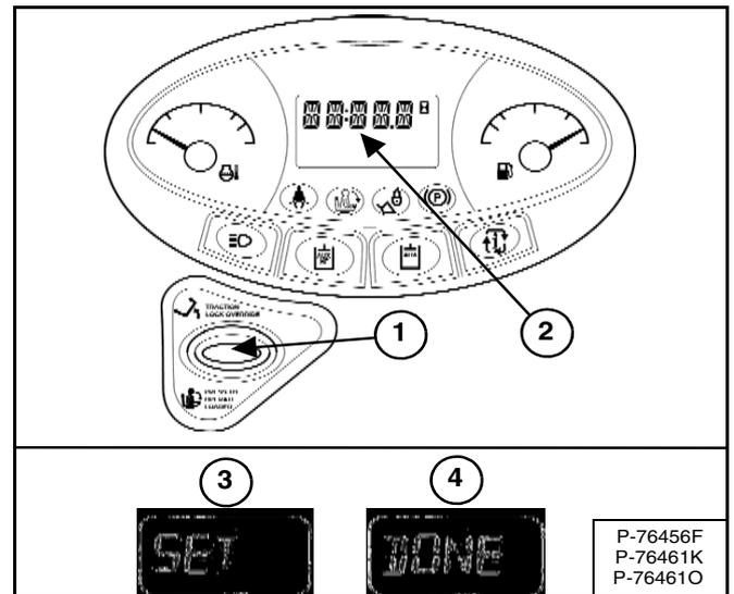
Enregistrement du réglage de la compensation de dérive de direction :
