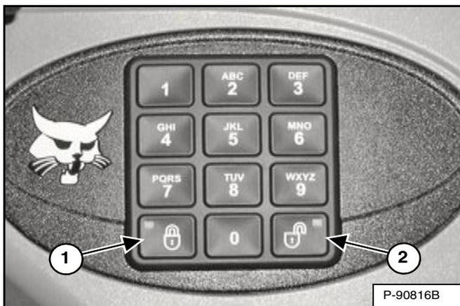
Enfoncez et maintenez les boutons de verrouillage (1) et de déverrouillage (2) [Figure SA-6] pendant deux secondes.
