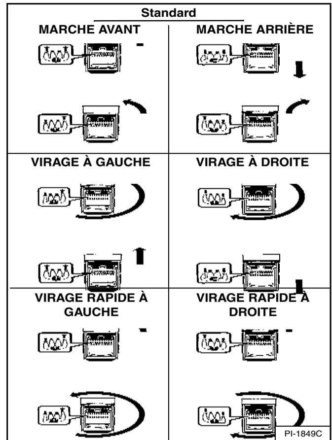
Les leviers de direction commandent la marche avant et arrière et les virages de la chargeuse [Figure OI-29].
