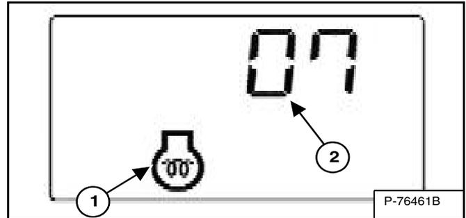
Si la température est basse, le préchauffage d'admission d'air (bougies de préchauffage) s'initialise automatiquement. L'icône du préchauffage du moteur (1) s'ALLUME et le temps de préchauffage est décompté sur l'affichage des données (2) [Figure OI-78].
