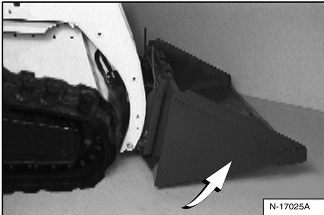
Inclinez le Bob-Tach vers l'arrière jusqu'à ce que le bord d'attaque du godet (ou autre accessoire) décolle légèrement du sol [Figure OI-105].
