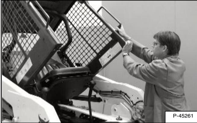
Levez lentement la cabine par la main courante et le bas de la cabine [Figure PM-16] jusqu'à ce qu'elle soit complètement levée et que son mécanisme de verrouillage s'enclenche.
