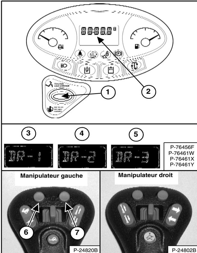
Enfoncez et maintenez le bouton PRESS TO OPERATE LOADER (1) pendant **trois secondes** pour régler la réaction d'entraînement de la chargeuse. Le réglage actuel de la réaction d'entraînement apparaît sur l'affichage des données (2) [Figure OI-42].
