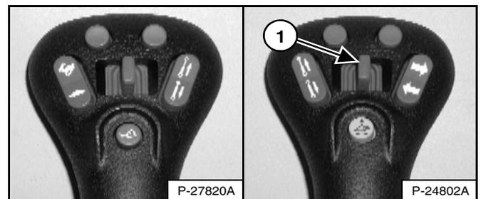
Déplacez le contacteur du circuit hydraulique auxiliaire avant (1) [Figure OI-57] vers la droite ou vers la gauche pour inverser le débit d'huile des raccords rapides avant. Si vous déplacez le contacteur à mi-course, la vitesse des fonctions auxiliaires est réduite environ de moitié ; relâchez le contacteur pour arrêter les fonctions auxiliaires (EXEMPLE : ouverture ou fermeture d'un grappin).
