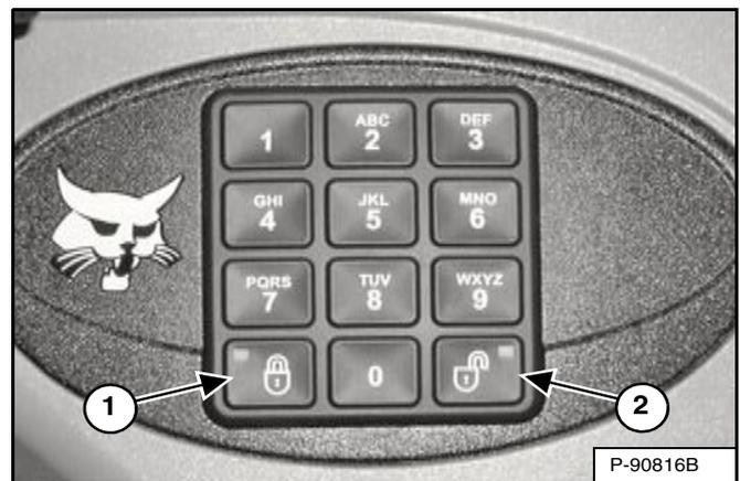
Appuyez sur le bouton de déverrouillage (2) [Figure SA-7].
