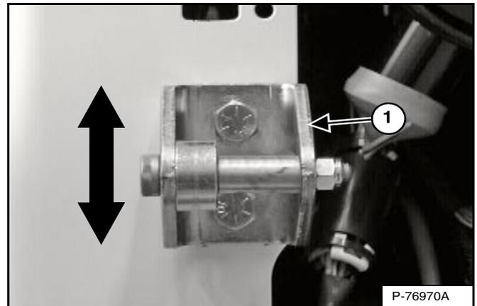
La butée de verrouillage de la porte (1) [Figure PM-23] peut être ajustée vers le haut ou le bas de façon à l'aligner sur le loquet.
