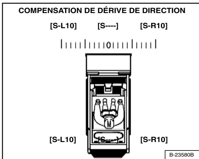
La compensation de dérive de direction comprend au total 21 réglages. La compensation de dérive de direction peut être réglée sur n'importe quel point entre le point neutre et [S-L10] à gauche et entre le point neutre et [S-R10] à droite. [S----] s'affiche lorsque le réglage est sur le point neutre [Figure OI-44].
