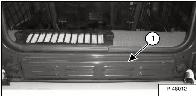
Le *filtre d'air frais* (1) [Figure PM-25] se trouve sous la vitre arrière, à l'extérieur de la cabine. Déposez les boutons de serrage, le couvercle du filtre et le filtre.
