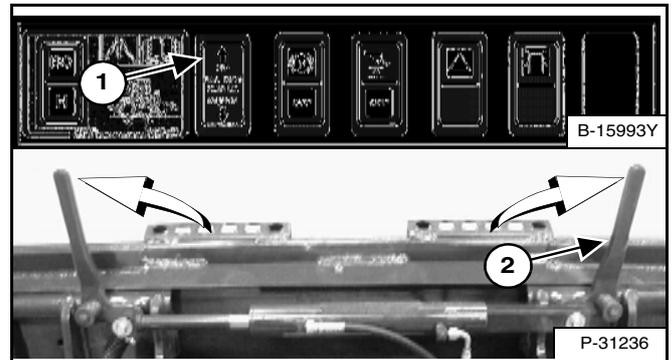
Maintenez enfoncé le côté UP du contacteur « BOB-TACH WEDGES » (montée des cales) (1) (panneau avant) jusqu'à ce que les leviers (2) [Figure OI-103] soient en position déverrouillée (cales complètement levées).
