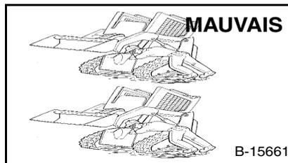
**!** Le débranchement ou le desserrage d'une conduite hydraulique, d'un flexible, d'un raccord, une pièce ou un composant défectueux peuvent provoquer la chute des bras de levage. Ne vous tenez jamais sous les bras de levage relevés s'ils ne sont pas maintenus par un arrêt de bras de levage approuvé. Remplacez-le en cas de détérioration.
