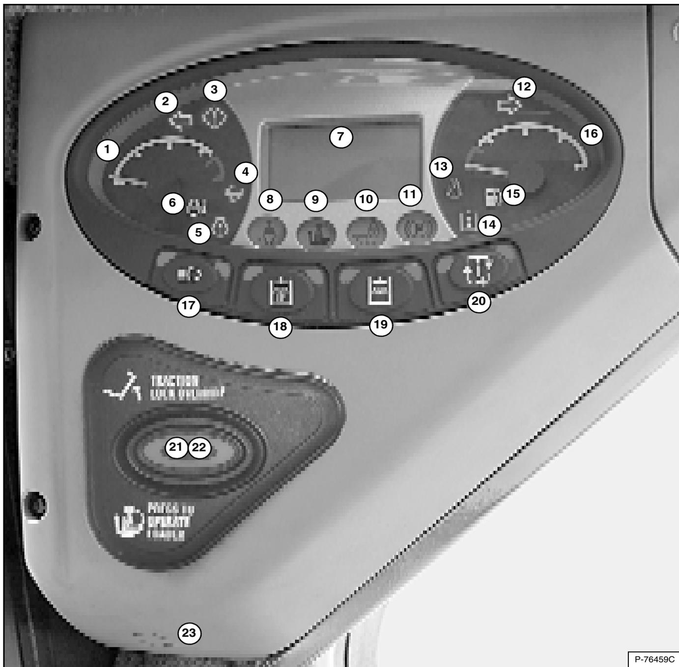
Les tableaux de bord gauche **[Figure OI-5]** sont identiques pour les machine à démarrage à clé standard, à démarrage sans clé et à tableau de bord Deluxe.
