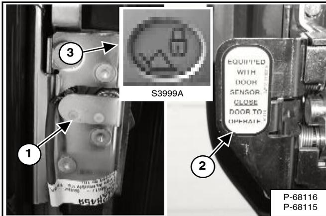
La porte de cabine est équipée d'un capteur (1) [Figure PM-19] qui désactive les fonctions de levage et de cavage lorsque la porte est ouverte.
