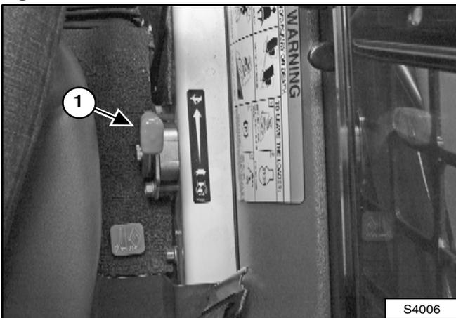
Placez la commande d'accélérateur (1) [Figure OI-76] en position de ralenti.
