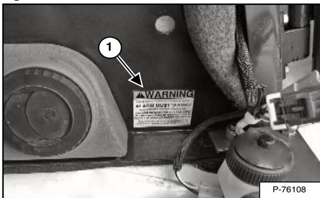
Vérifiez que l'autocollant d'alarme de recul (1) [Figure PM-11] n'est ni endommagé ni manquant. Remplacez-le si nécessaire.
