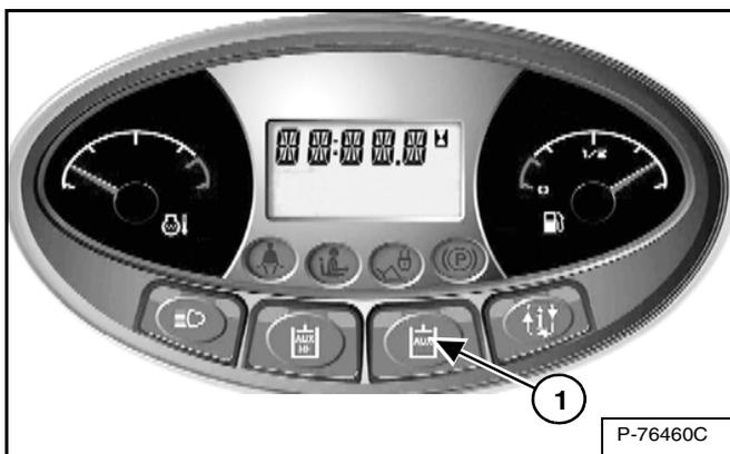
Appuyez sur le bouton des auxiliaires hydrauliques (1) [Figure OI-63].
