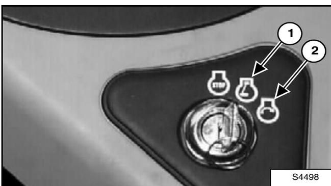
Tournez le contacteur à clé sur la position MARCHÉ (1) [Figure OI-77]. Les témoins du tableau de bord gauche s'ALLUMENT brièvement tandis que le tableau de bord / système de surveillance exécute un test automatique.
