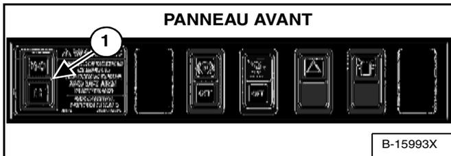
(SJC) Sélectionnez le schéma de commande ISO ou H (1) [Figure OI-79].
