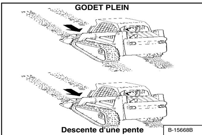
Quand le godet est plein, montez ou descendez une pente en dirigeant l'extrémité lourde de la machine vers le haut de la pente [Figure OI-114] et [Figure OI-115].
