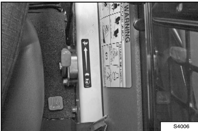
Placez la commande d'accélérateur en position de ralenti [Figure OI-81].
