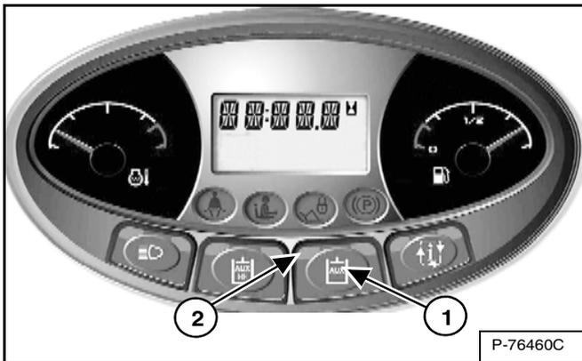
Appuyez une fois sur le bouton des auxiliaires hydrauliques (1) [Figure OI-58] pour les activer.
