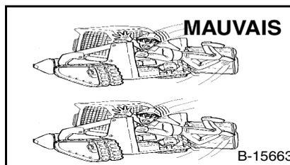
**!** Maintenez le corps, les bijoux et les vêtements à l'écart des pièces mobiles, des contacts électriques, des pièces brûlantes et de l'échappement.
