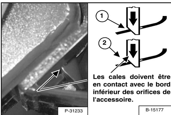
Les cales (1) [Figure PM-80] doivent dépasser des orifices du châssis de fixation de l'accessoire.
