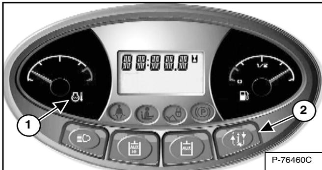
Vérifiez régulièrement les jauges de température et de carburant ainsi que les témoins BICS™ (tous doivent être ÉTEINTS pour utiliser la chargeuse) [Figure OI-91].
