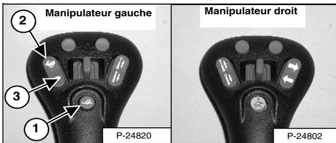
Appuyez une fois sur le bouton (1) [Figure OI-38] du manipulateur gauche pour activer la commande de gestion de la vitesse.
