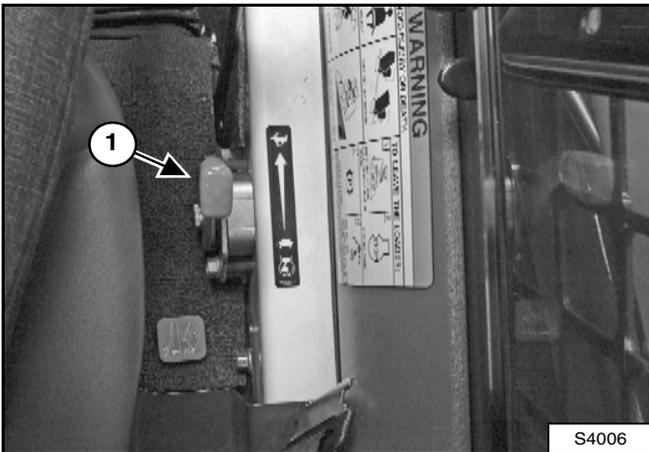
Placez la commande d'accélérateur (1) [Figure OI-86] en position de ralenti.
