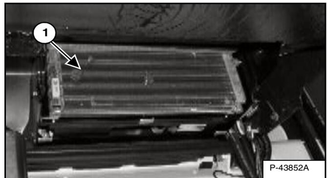
Nettoyez le faisceau du chauffage (1) avec de l'eau ou de l'air à basse pression pour retirer tous les débris [Figure PM-28].
