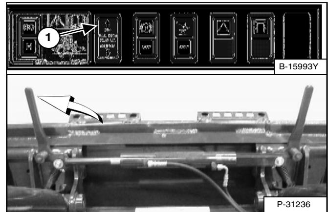
Enfoncez et maintenez le côté UP du contacteur « BOB-TACH WEDGES » (montée des cales) (panneau avant) (1) [Figure OI-107] jusqu'à ce que les cales soient complètement relevées.
