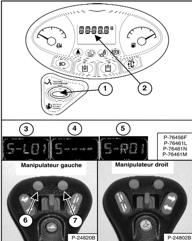
Enfoncez et maintenez le bouton PRESS TO OPERATE LOADER (1) pendant **trois secondes** pour ouvrir le menu de réglage de la réaction d'entraînement. Enfoncez de nouveau le bouton PRESS TO OPERATE LOADER (1) pour régler la compensation de dérive de direction de la chargeuse. Le réglage actuel de compensation de dérive de direction apparaît sur l'affichage des données (2) [Figure OI-45].
