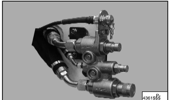
**Connexion** : éliminez les saletés ou débris accumulés sur la surface des raccords mâles et femelles ainsi que sur le diamètre extérieur des raccords mâles. Contrôlez visuellement les raccords pour vous assurer qu'ils ne présentent pas de corrosion, de fissure, d'endommagement ou d'usure excessive. Dans le cas contraire, remplacez le(s) raccord(s) concerné(s) [Figure OI-61] ou [Figure OI-62].
