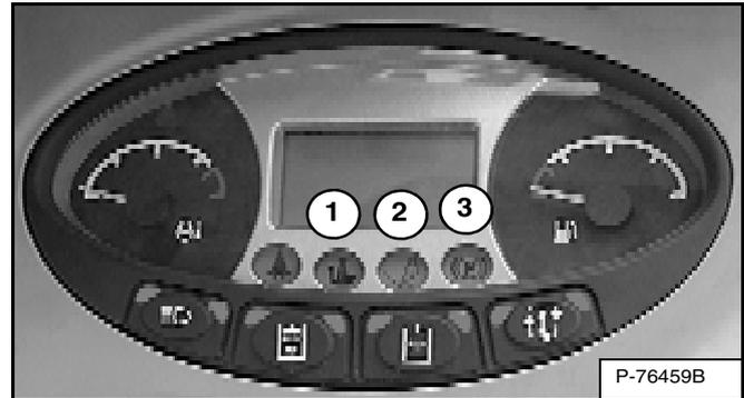
Les trois témoins (1, 2 et 3) [Figure OI-17] du tableau de bord gauche doivent être ÉTEINTS pour utiliser la machine avec toutes ses fonctions.
