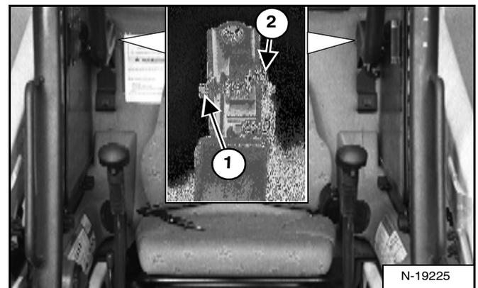
Éliminez les débris ou les saletés des points pivots à l'air comprimé. Ne lubrifiez pas. Contrôlez la visserie de fixation. Le couple de serrage correct du boulon d'articulation (1) est de 25 - 28 ft.-lb. (34 à 38 Nm). Le couple de l'écrou du capteur de l'arceau de siège (côté gauche uniquement) (2) [Figure PM-3] est de 50 - 70 in.-lb (6 - 8 Nm).
