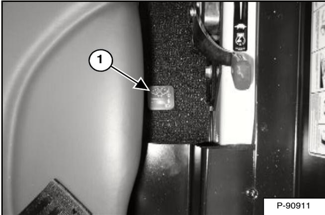
La commande de dérivation des bras de levage (1) [Figure OI-18] sert à abaisser les bras de levage au cas où ils ne peuvent pas être abaissés normalement.
