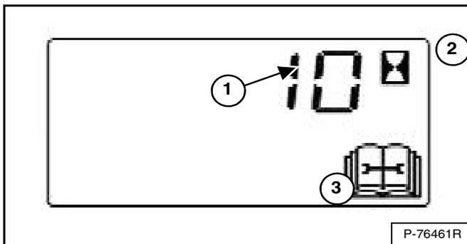
Pendant l'utilisation de la machine, une alarme à deux signaux sonores retentit lorsqu'il reste moins de 10 heures jusqu'au prochain entretien périodique.
