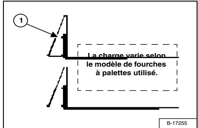
La charge maximum à porter en utilisant les fourches à palettes est indiquée sur un autocollant situé sur le châssis des fourches (1) [Figure OI-96].
