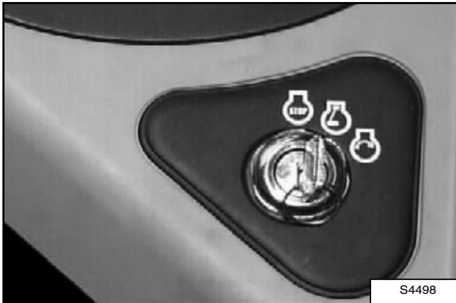
Cette machine peut être équipée d'un tableau standard à contacteur à clé [Figure OI-7].
