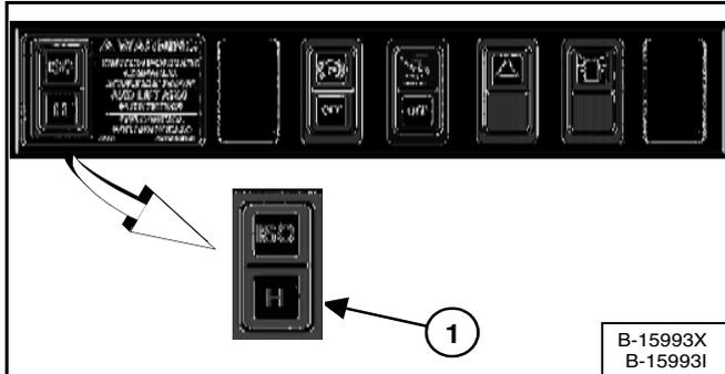
Sélectionnez le schéma de commande H en appuyant sur le bas du contacteur (1) [Figure OI-33].
