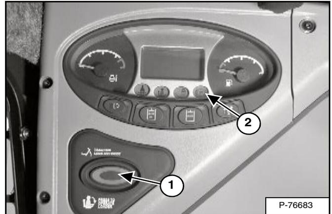
(Fonctionne uniquement lorsque l'arceau de siège est relevé et que le moteur tourne). La commande de déverrouillage de la transmission (1) [Figure OI-20] se trouve sur le tableau de bord gauche. Elle permet de déplacer la chargeuse en marche avant ou arrière à l'aide des leviers de direction en cas d'utilisation de la pelle rétro ou pendant un entretien de la chargeuse .
